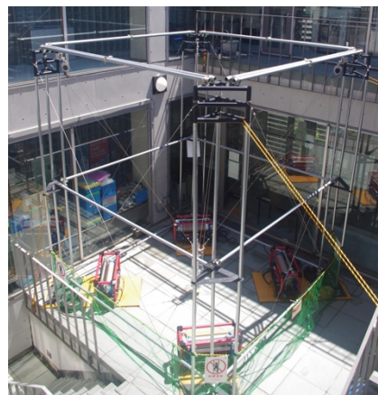
図 1. 建築スケール 3D プリンタ ArchiFAB「NIWA」
