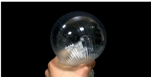
図 4. 造形した膜に空気を入れた様子
