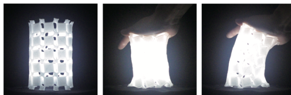
図 7. オーゼティックパターンを潰した時の挙動
