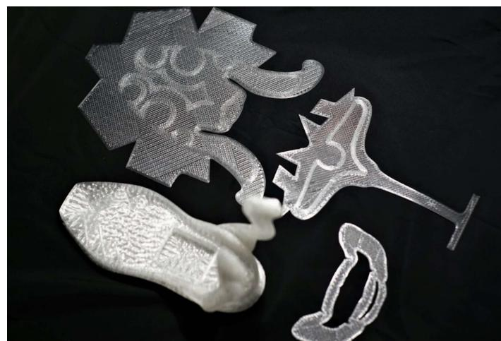
Fig.27 左上; アッパー(前), 右上; アッパー(後), 左下; アウトソール+支柱, 右下; 脣あて
