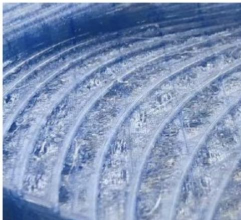
図 72 積層面割れのプリントエラー
