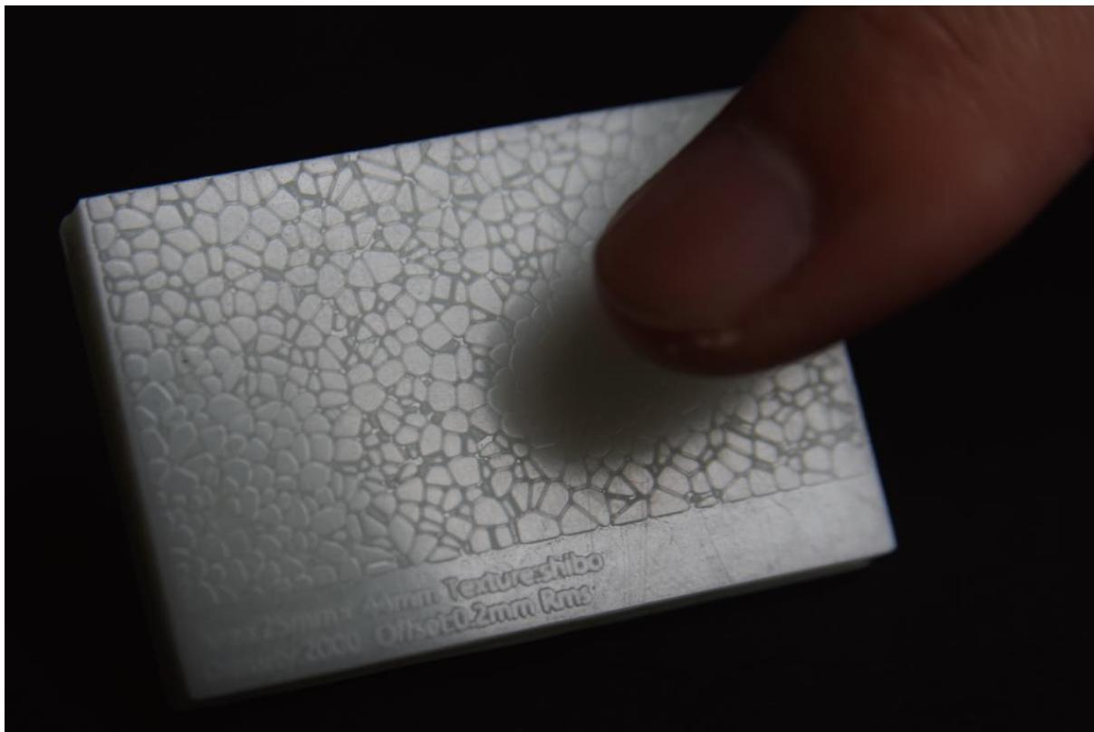
Fig. 28 分割数2000、オフセット距離0.2mmの出力サンプル
