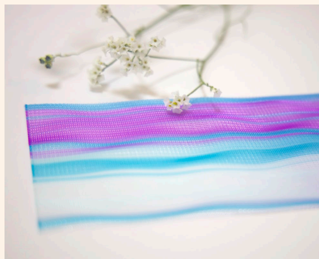
Fig. 02: G-code の自作によりテクスチャと色の制御をした構造
