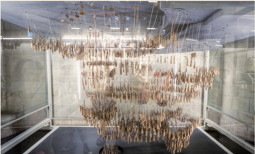
Fig.11: サグラダファミリアの逆さ吊り実験の復元模型 [33]
