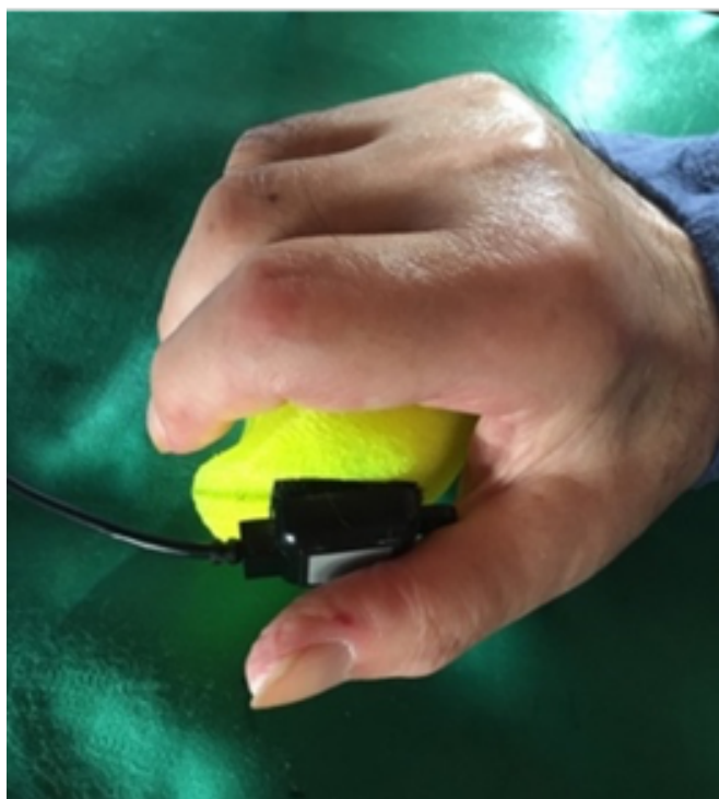
Fig.41 スwitchの土台となる自助具を3Dプリンタで製作した例
