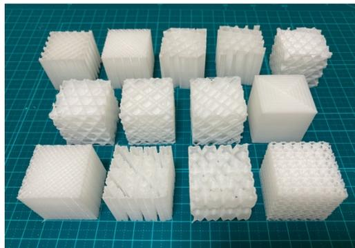
[Fig.4-3-1] Ultimaker Curaによる13種類のインフィルパターン
