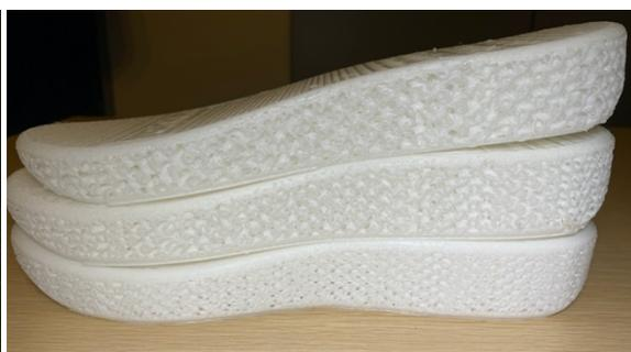
[Fig.4-3-6] top layer の厚みが同じで密度が異なるソール (上から 12%、15%、20%)
