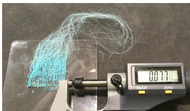
図 4.3.3-2 ヘアプリントの毛の太さ測定
