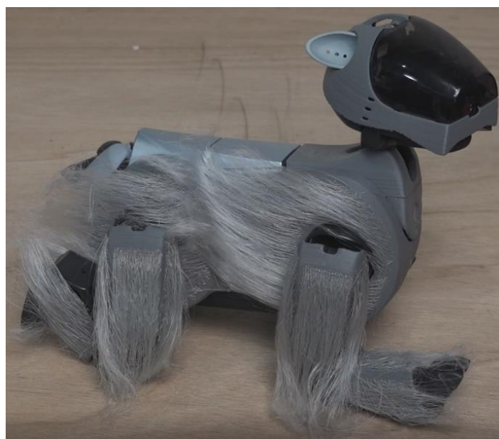
図 5.2-1 AIBO に植毛した例
