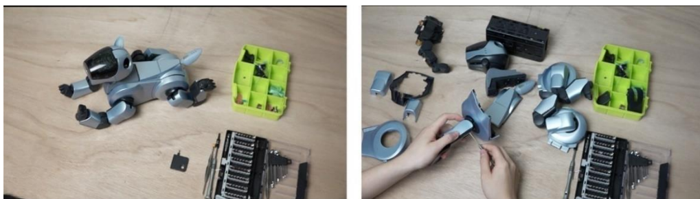
図 4.2.4-2 AIBO の分解過程
