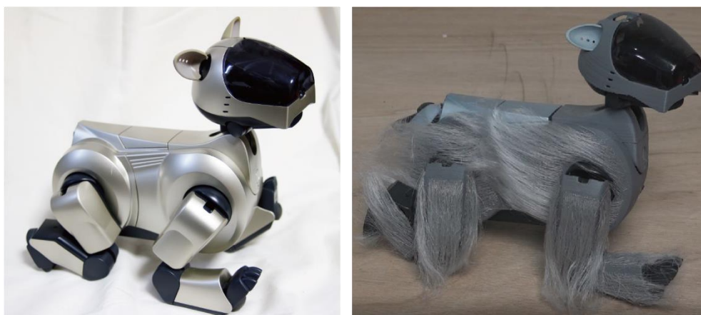
図 6.2.2-1 AIBO 植毛前：左 と植毛後：右
