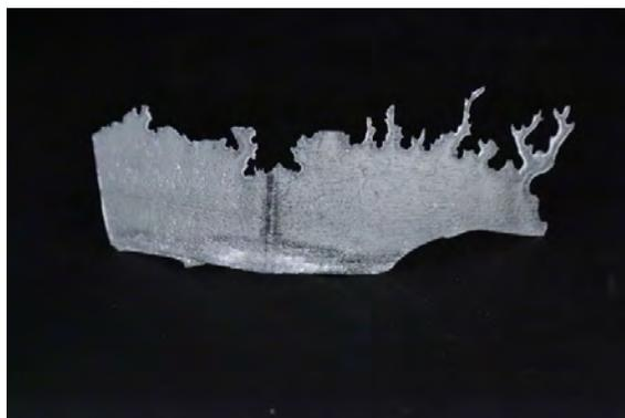
図 44 バリに転写されている積層痕
