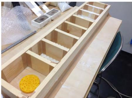
図 35 一度に型を取るための枠
