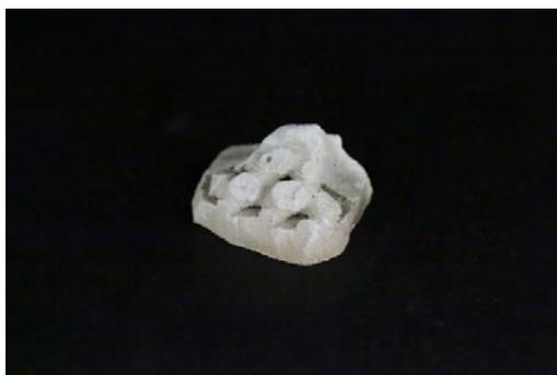
図 43 焼成後も積層痕の残る石膏の欠けら
