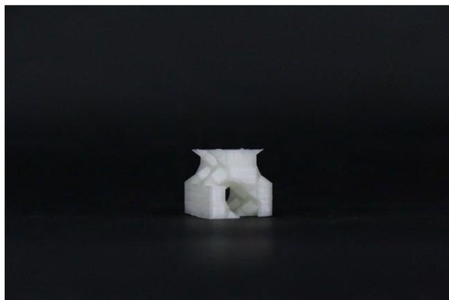
図 21 3D プリンタで出力した内部構造の 1 単位
