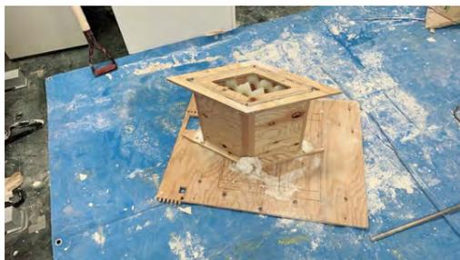
図 32 治具を用いた木枠の例
