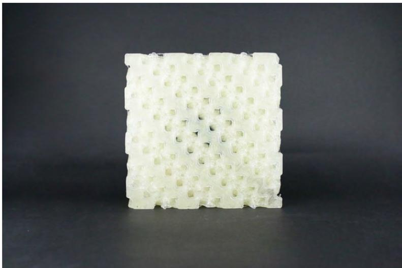
図 28 荒い積層ピッチで出力された確認用モデル
