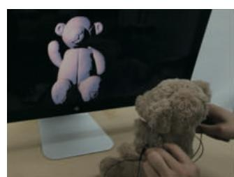
図6.20: 人形玩具型インターフェースの外観 (A)FoamSense 設置の様子, (B)FoamSense 導入後の柔軟性の様子, (C)FoamSense により画面内のオブジェクトを操作する様子
