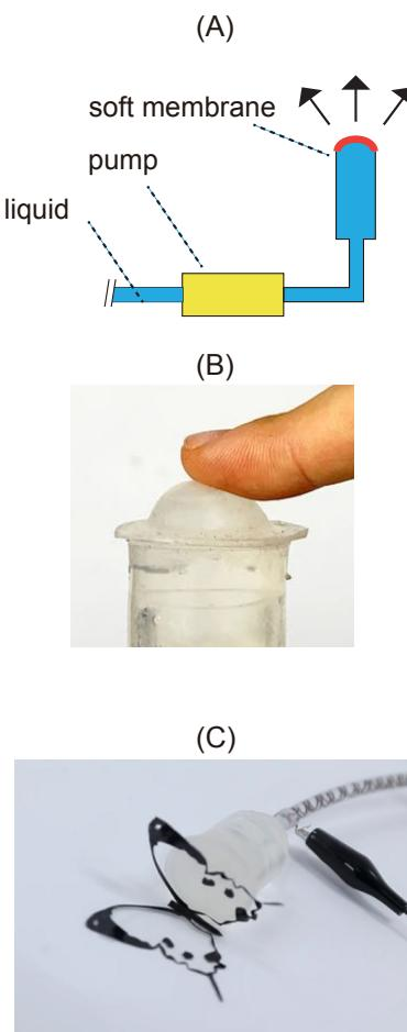
図8.20: EHDポンプによる形状変形 (A) エラストマー膜を変形させる原理, (B) シリコーンエラストマーを膨らませている様子, (C) 膨らませたエラストマーにより柔らかな構造体を動かす様子
