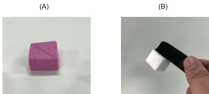
図6.23: 異なる機能性インクを染み込ませた FoamSense, (A) ロイコ染料を染み込ませた FoamSense, (B) フェライトを染み込ませた FoamSense(黒色), 表面にネオジム磁石を固定したスポンジ (白色)
