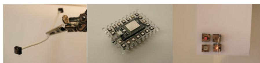
図4.7: 提案手法の概要 (A) 磁性と硬化の機能を付与したマテリアル, (B) 提案手法で作成した三次元の硬い構造体, (C) マグネット式電子部品モジュール
