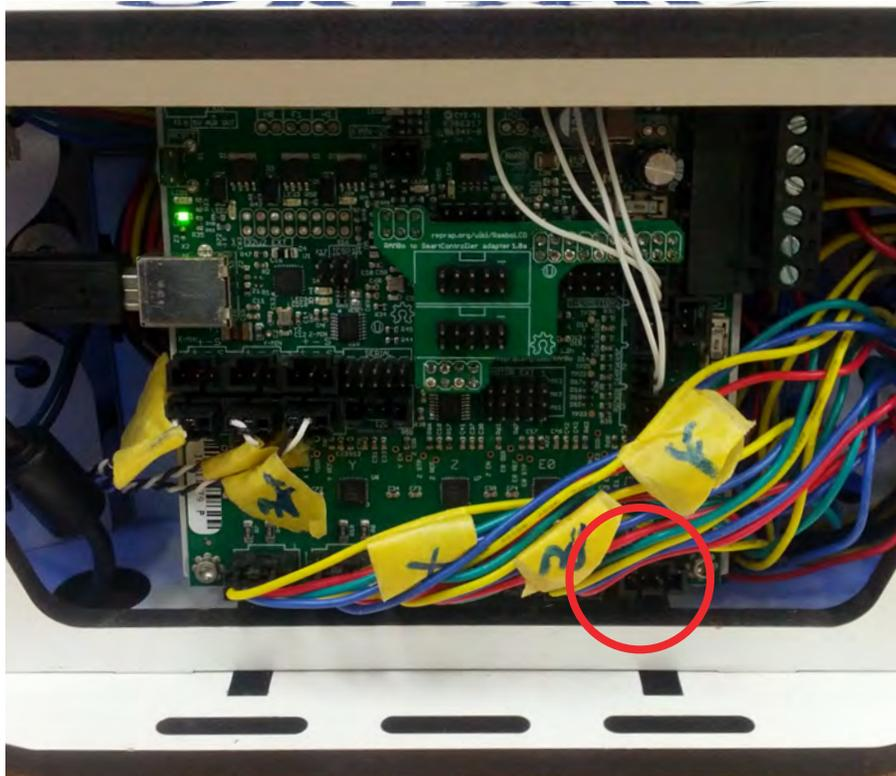
2. 上の図で赤い丸で囲った部分にE1の表示があり、その部分のハウジングが空いていることを確認。このあとコネクタを取り付けるが、万が一に備え、各ケーブルに上図のようにラベリングを行っておくとよい。
