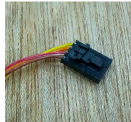
どれが電源のケーブルであるかは、コイルごとに、三本のうちケーブルを二本ずつ選び、その抵抗を計ることで識別可能である。すべての組み合わせのうち、一番抵抗が高い二つのケーブルの組み合わせのとき、それ以外の一本を接続しなければよい。
