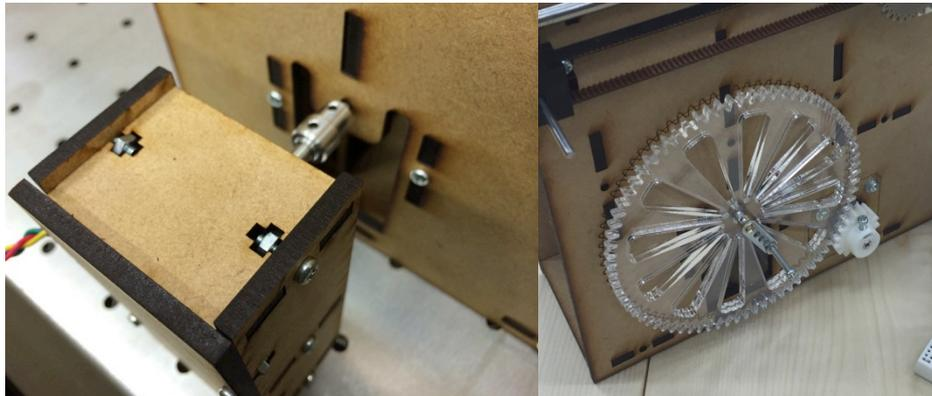
図 22 モーター直結型 (左)、ギアによるトルク増強後 (右)
