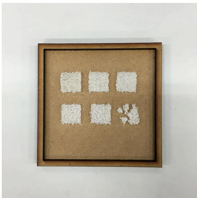
図 40 レーザー照射後の造形物
