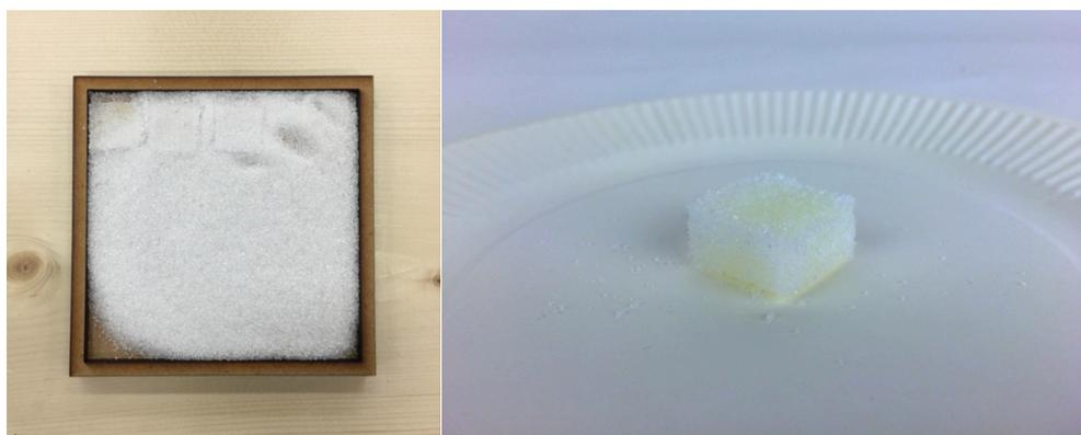
図 36 砂糖の検証結果 (左から power 20 15 10 5) と 3D プリントサンプル
