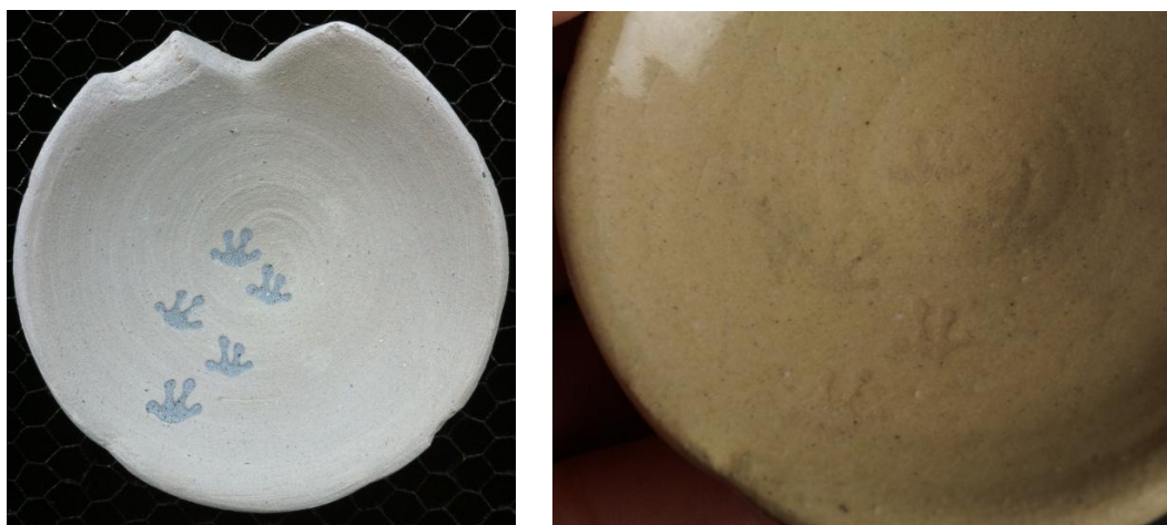
【図 10】 乾燥後にレーザーを照射したもの（左：焼成前／右：焼成後）
