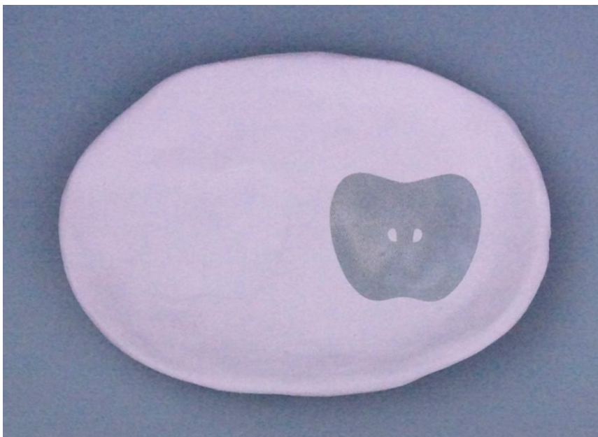
【図 33】 施釉薬後にレーザー加工した器
