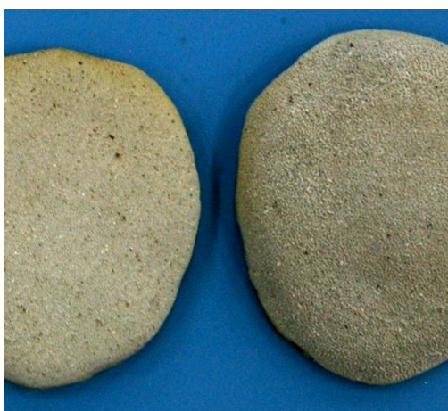
【図 14】 レーザー照射後の陶土（左：1度照射／右：2度重ねて照射）
