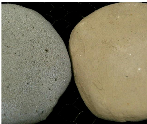
【図 13】 オープン陶土（左：レーザー照射後／右：レーザー照射前）
