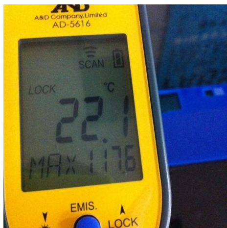
【図 22】非接触温度計によるレーザー照射時の素材の表面温度計測（アクリル）
