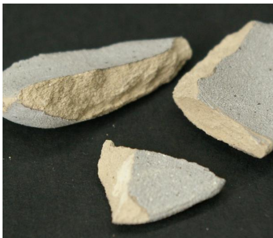
【図 16】 表裏両面からレーザー照射した後、手で割った陶土の破片
