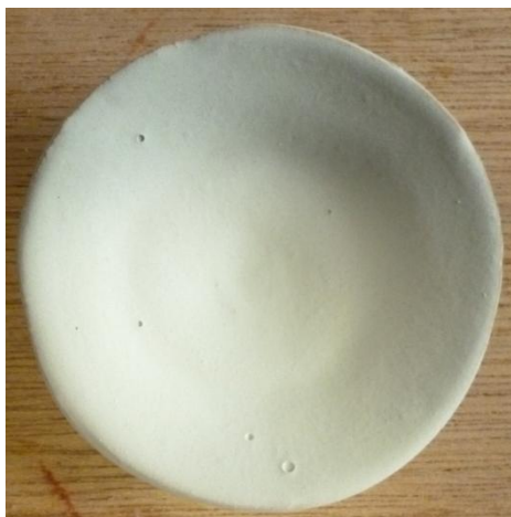
【図 17】 レーザー照射前の施釉された陶器
