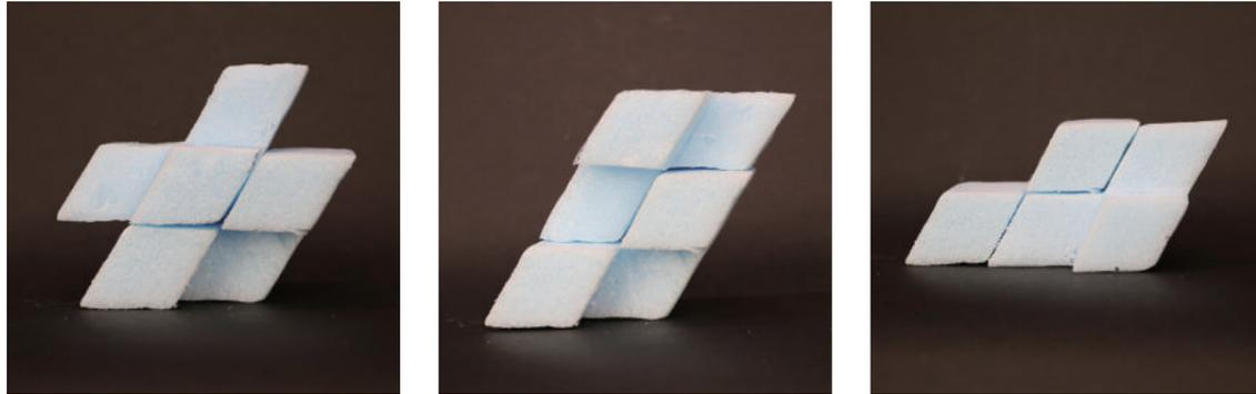
凹型と凸型、2種類のモジュールを作成したことにより、ピース同士の組み合わせが可能になった。
