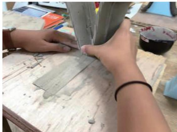
5. 接地面及び他のモジュールと連結する頂点部分をやすりがけして平面出しをする。
