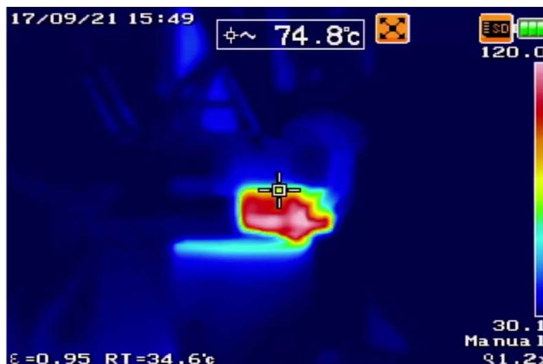
図 39 サーモカメラで造形中の様子を撮影した動画のキャプチャー。
