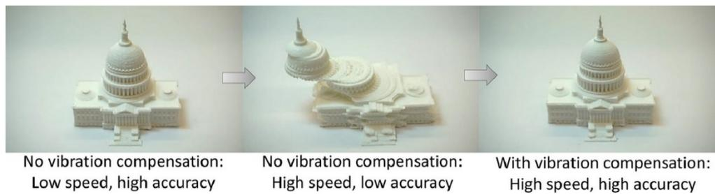
図 15 印刷速度を上げても造形物が形状を保ったまま出力されている様子。アルゴリズムは既存の 3D プリンタのファームウェアに組込むだけで利用でき、ハードウェア側のアップグレードも必要ない。
