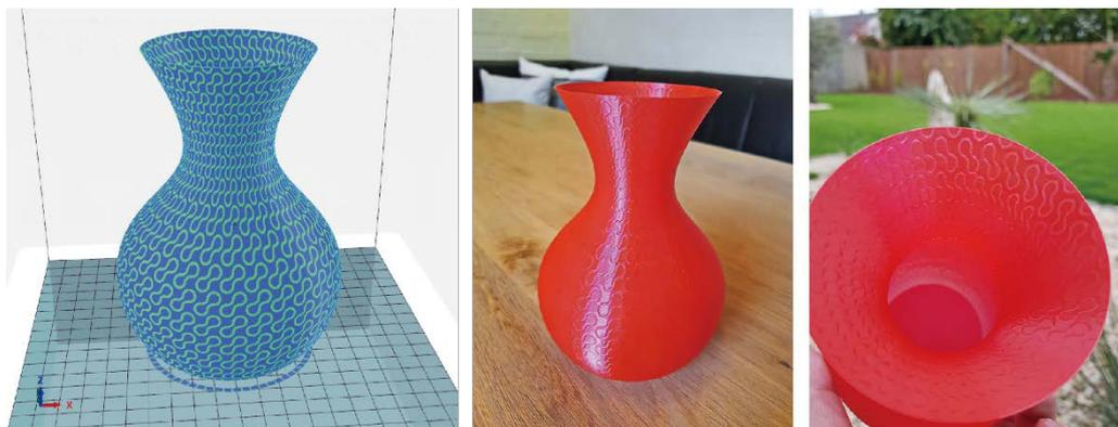
図 28 (左) モデルに画像を UV マッピングしたものと、(右) 出力されたもの。
