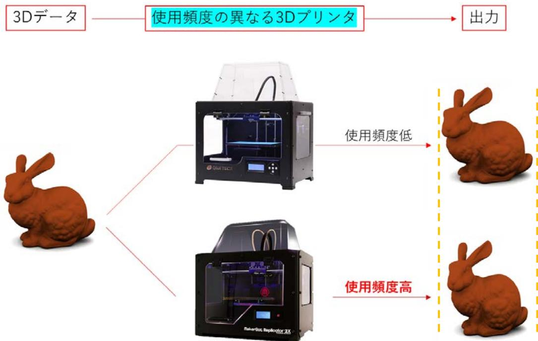
図3 使用頻度の違いが出力物の縮尺に影響する下りの図解。
