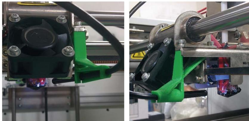
図 36 ヘッドに M-935 を取り付けた様子。
