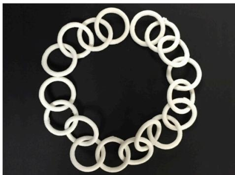
3Dプリンターで出力し、焼成した鎖状の陶磁器。
