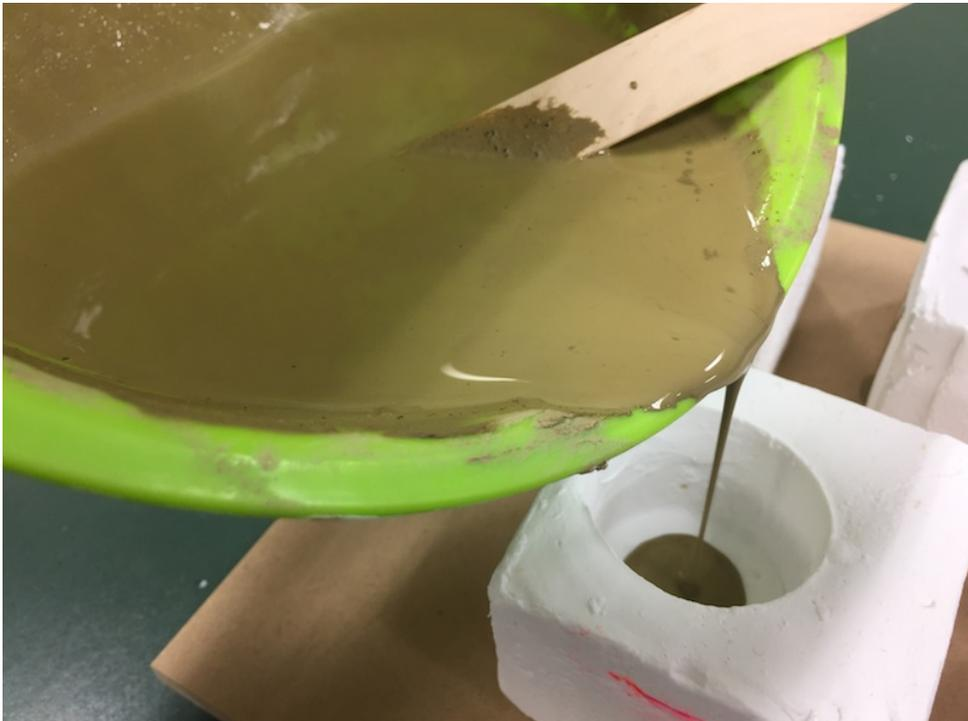
図54 泥漿を流し込む様子
