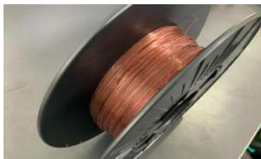
図3. フィラメント製造機で巻き取ったたまごパック
