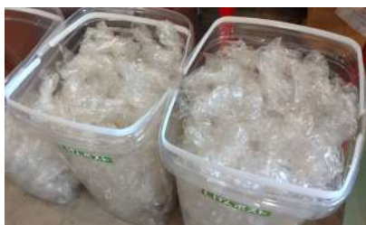
図1. 前処理を行ったプラスチック製たまごパック
