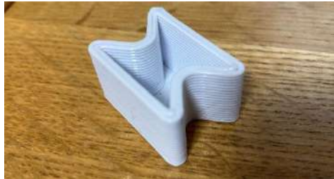
図 6. 製作した楔形ジョイント
