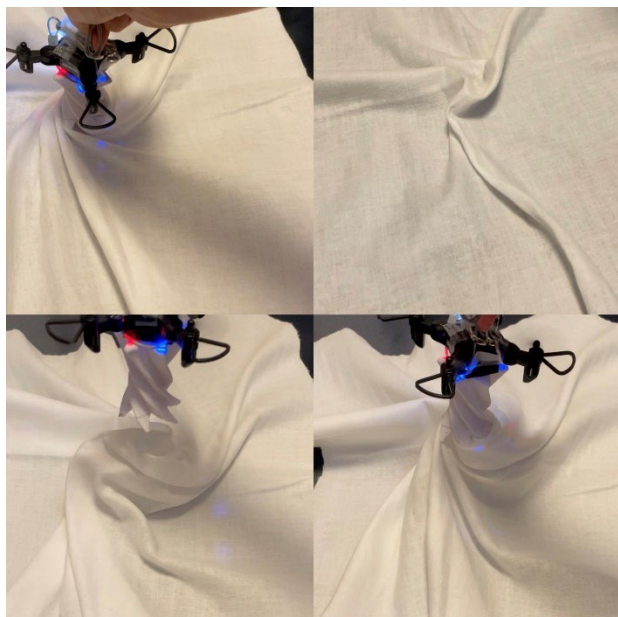
図8 ツイストランディングギアに布が巻き込まれる様子
