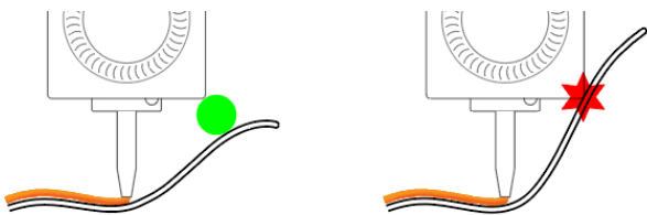
図10. 機械との衝突例
