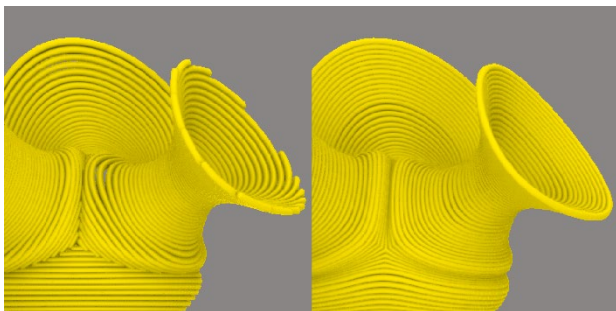
図16. 左:平面スライス 右:非平面スライス
