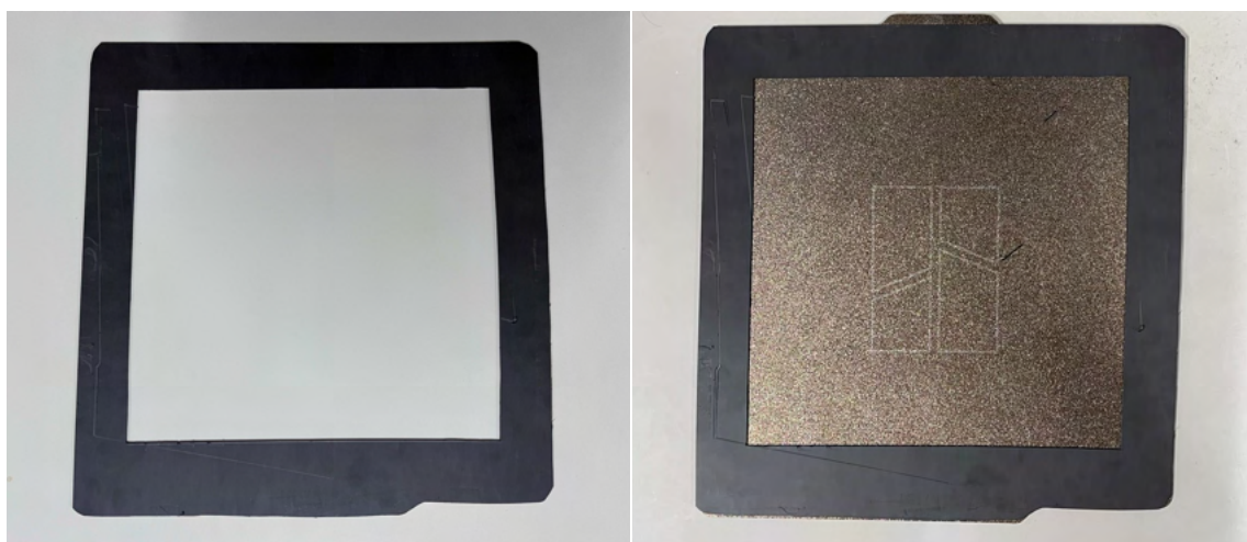
図 40: 布固定用のゴム磁石フレーム
