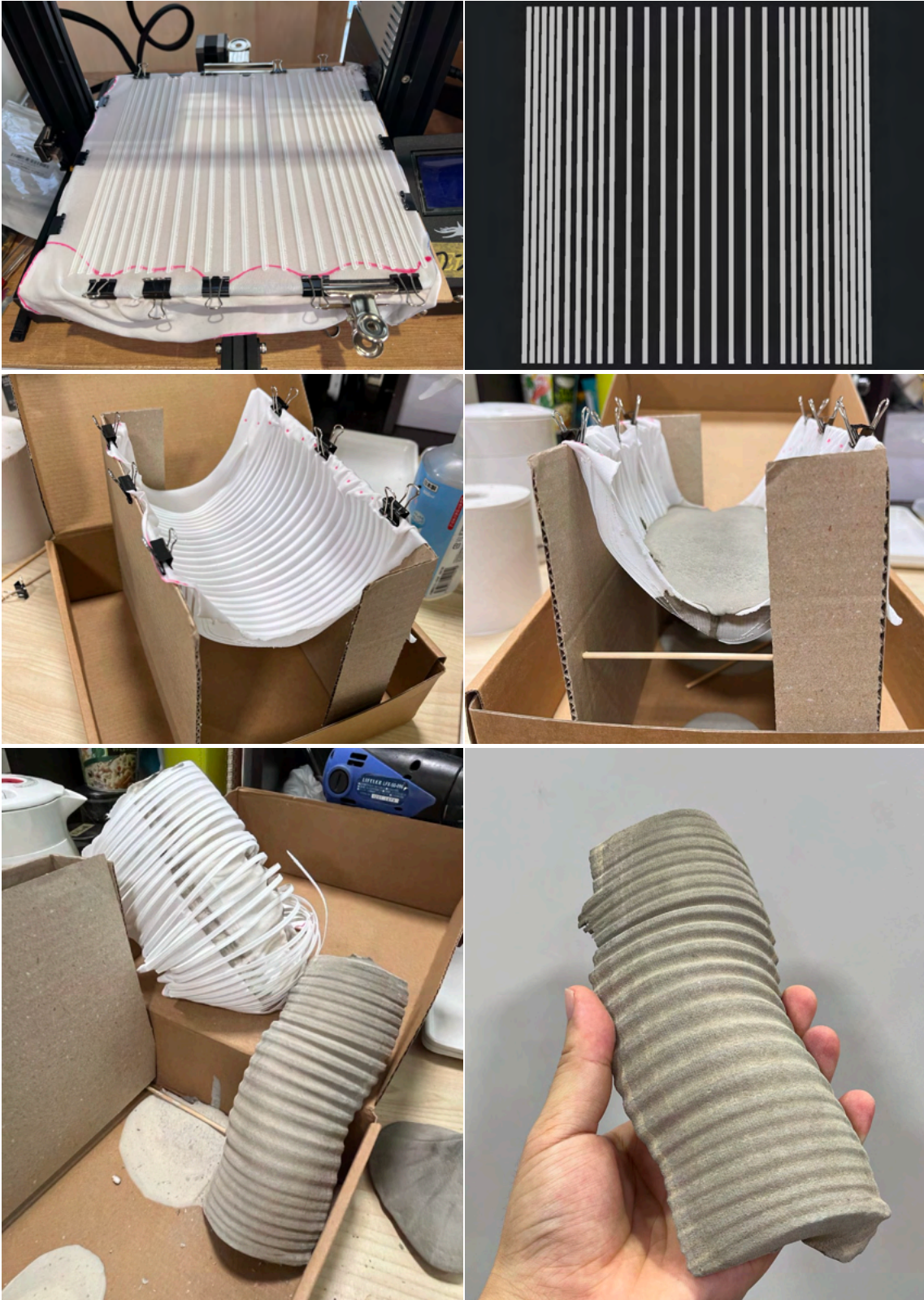
図 54: アーチの布型枠にコンクリートを流し込むから離型までの様子
