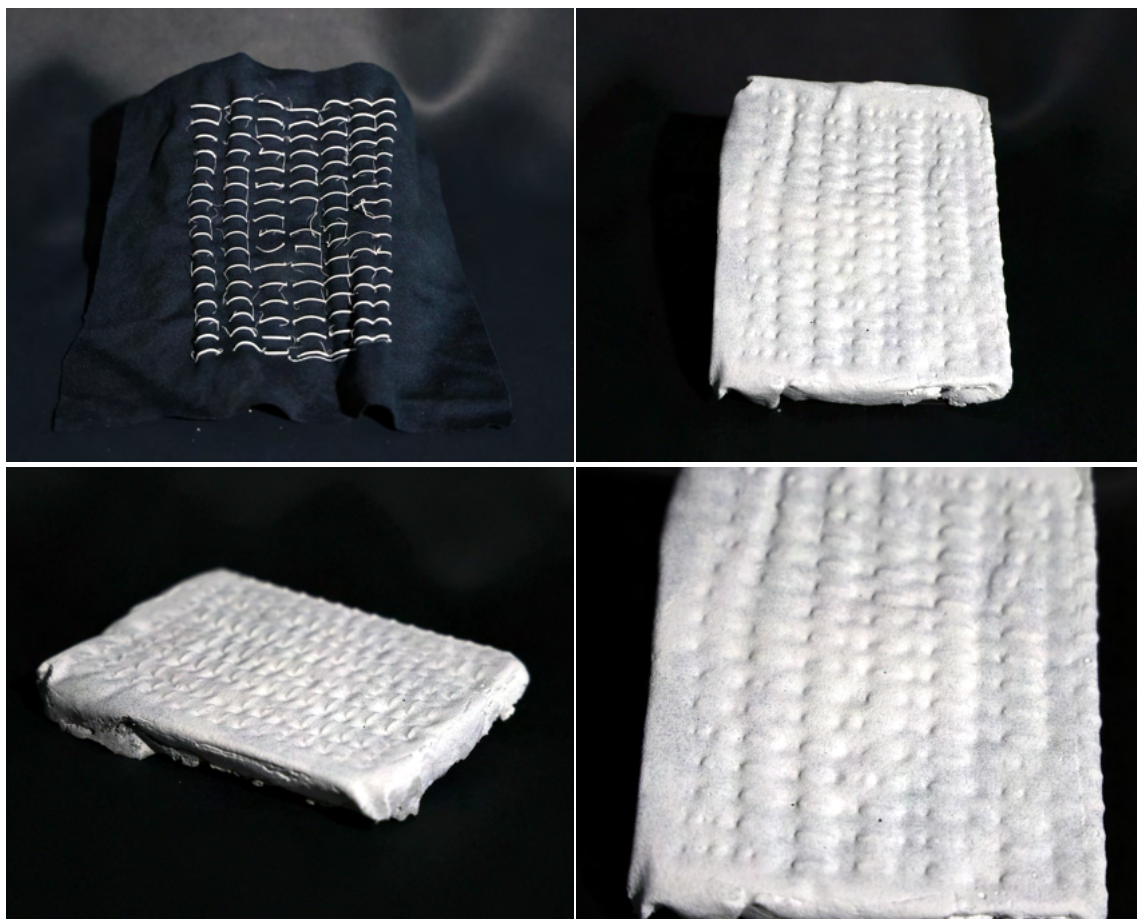
図 59: 刷毛塗布法に使った布型枠と離型したコンクリート
