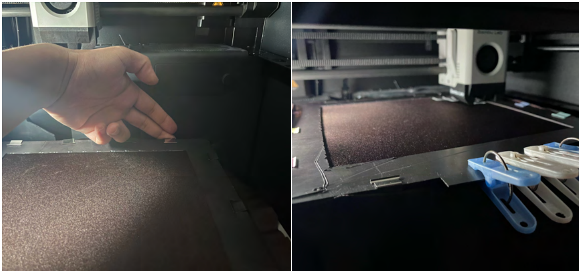
図 44: ゴム磁石を設置する時の注意点
