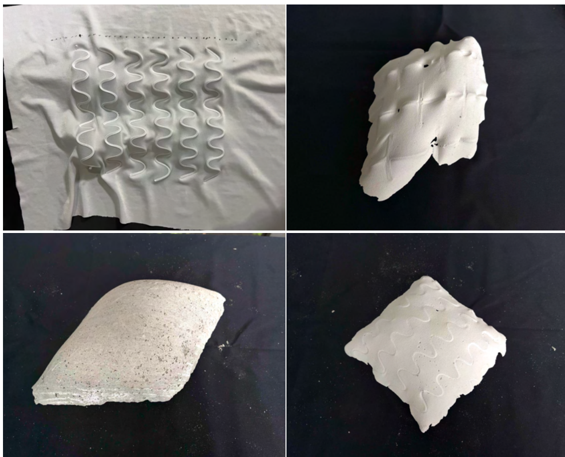
図 57: コンクリート一括充填法に使った布型枠と離型した制作物
