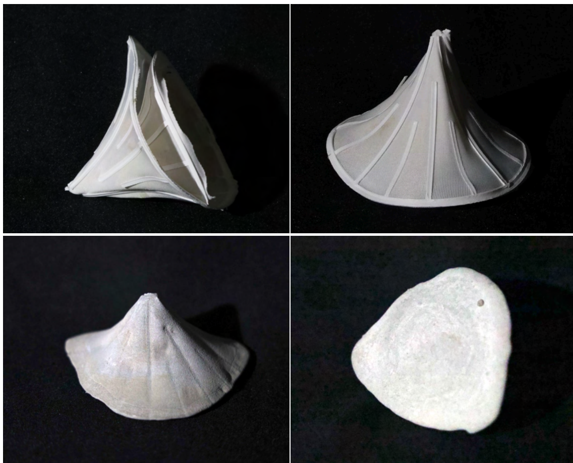
図 51: 円錐状の布型枠と作られたコンクリート
