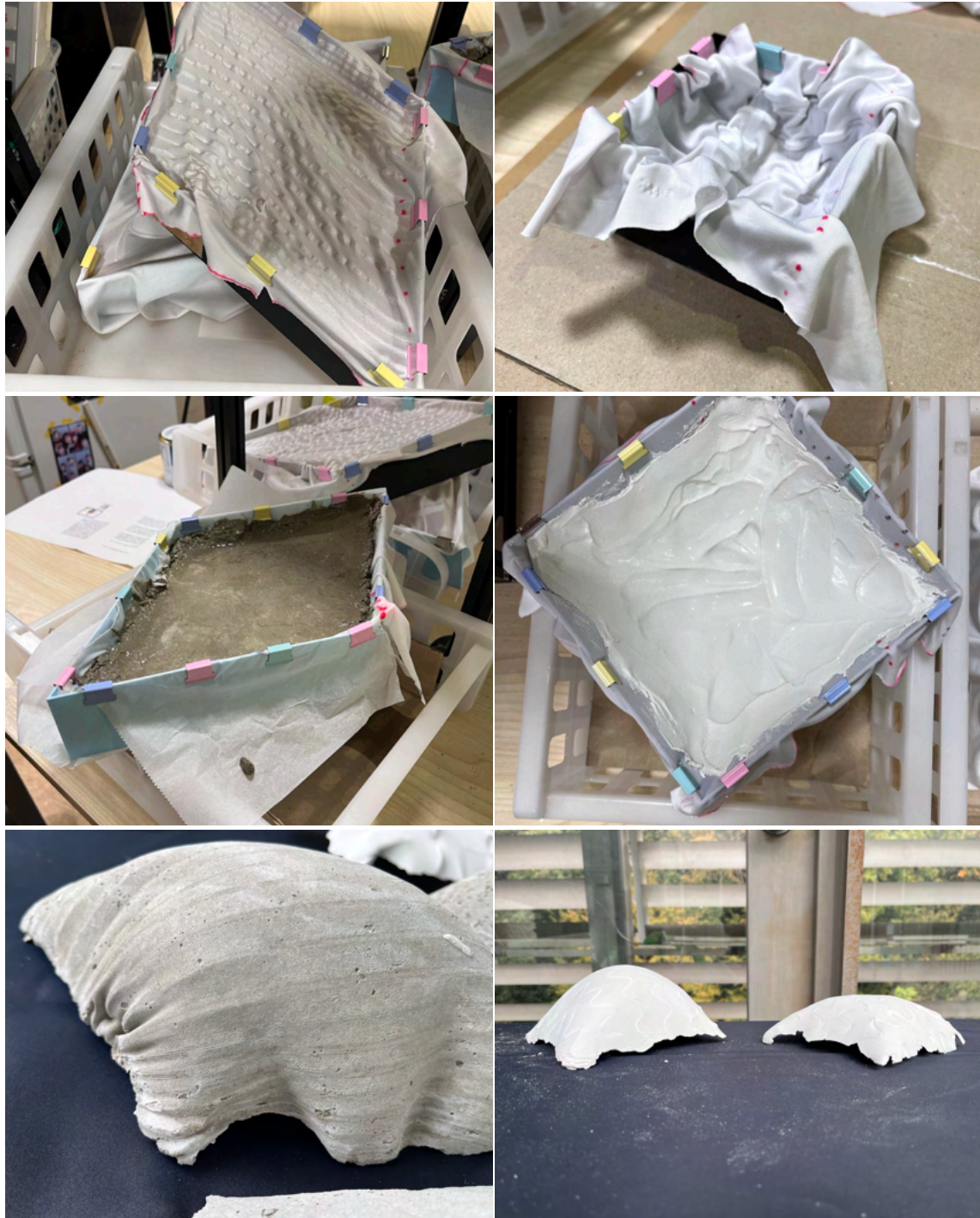
図 58: 自己形成布地に 3D プリント型枠に打設と離型の様子
