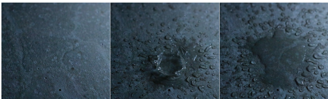
図 72: 多孔質のコンクリートに濡れると質感の変化 (撮影者：筆者)
