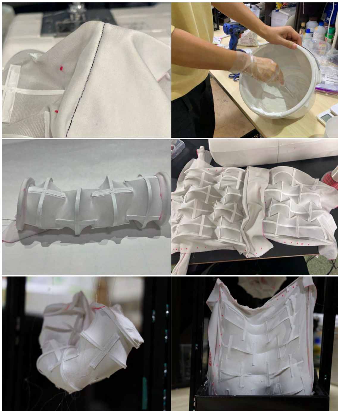
図 56: ミシンで布型枠を制作し、その中にコンクリートを流し込む様子
