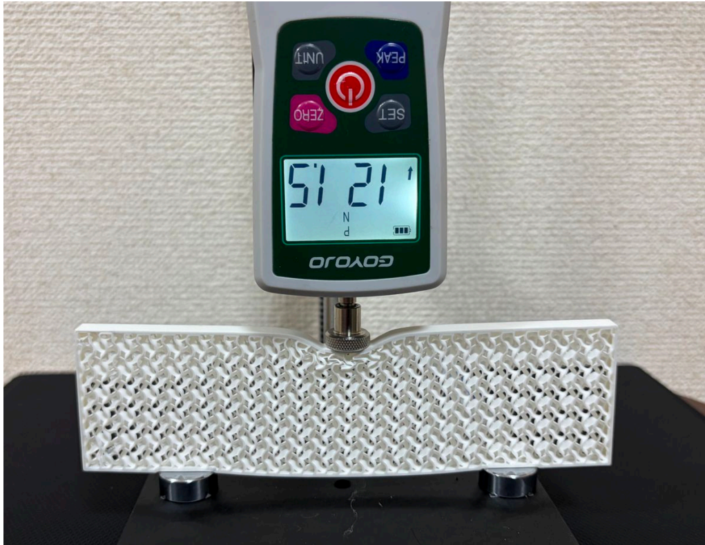
Figure 53: 均一インフィル試験片の最大荷重と圧壊挙動
