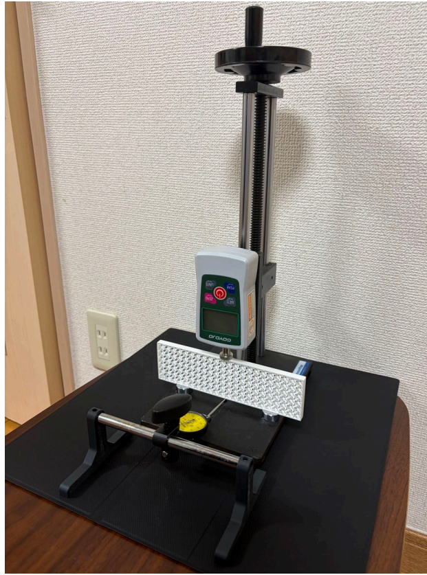
Figure 51: 三点曲げ試験装置の構成
