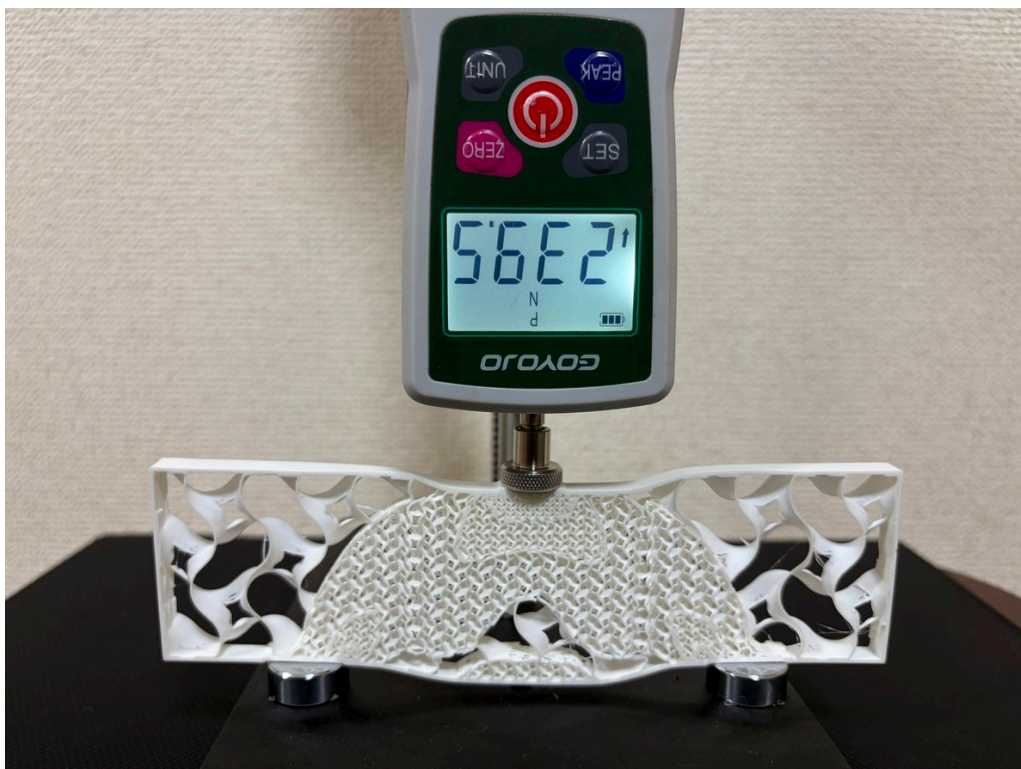
Figure 54: 提案手法 (Strecs3D) のピーク荷重と破壊挙動
