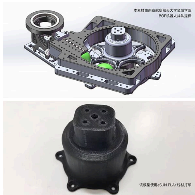
Figure 2: 南京航空航天大学のロボットチームのボール押し出し機構 (Source: https://www.esun3d.com/news/9900/ )
