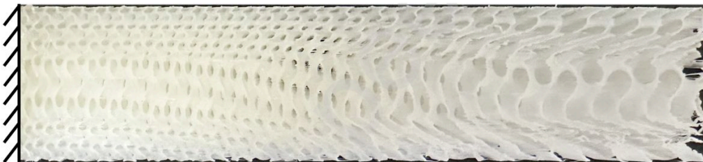
Figure 17: Wegner らによる局所的な密度変化のある Gyroid 構造 (Source: Wegner et al., 2025 より引用)
