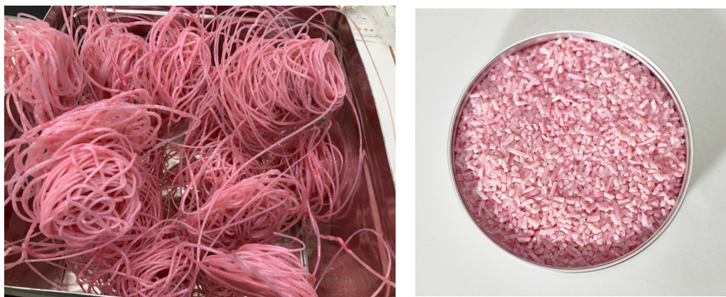
図22. 2mmノズルの押出機で押出した渦状の塊と、粉碎して得られたペレット
