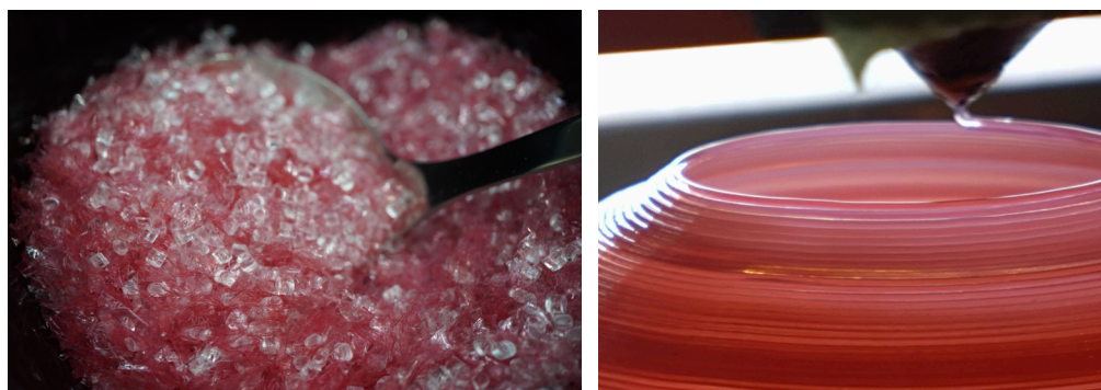
図20. A-PETフレークとPETGペレット混合物と造形物
