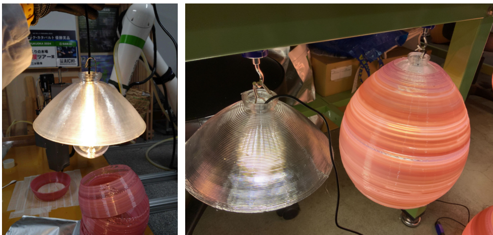
図34. 卵型ランプシェードの構造
