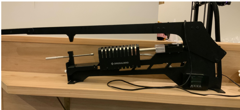
図16. 手動式射出成型機（株式会社オリジナルマインド：INARI M12）
