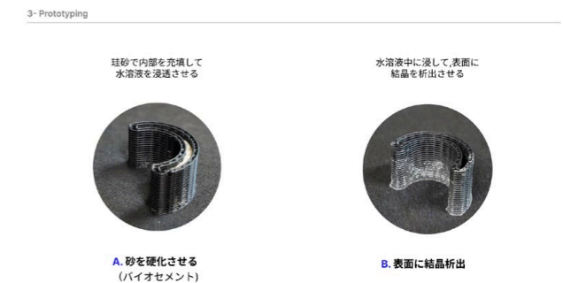
Fig. 12 | 1/10 スケールのプロダクト模型制作。
