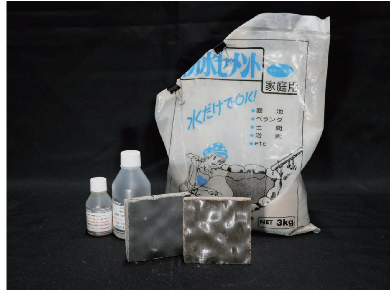
fig4. 光沢斑紋コンクリートとその構成材料
