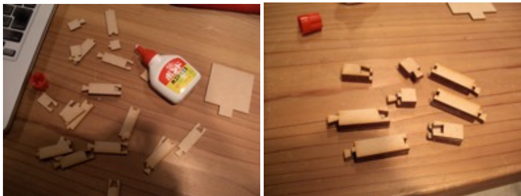
(図4-4レーザーカッターによる蟻継ぎの制作)
